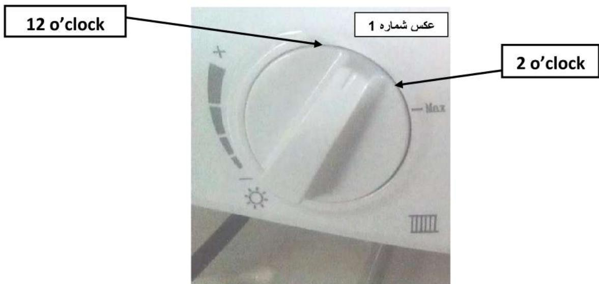
کلید چرخان تنظیم درجه حرارت آب گرم مصرفی(کلید چرخان سمت راست) را تا انتهای به سمت چپ بچرخانید و سپس کلید تعیین وضعیت(کلید وسط) را بچرخانید تا روی حالت SET قرار گیرد. سپس کلمه "SET" بر روی صفحه نمایشگر LED ظاهر می شود.(طبق عکس شماره ۲)
